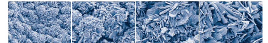
REM-Aufnahmen einer BONIT®-coating Oberfläche
