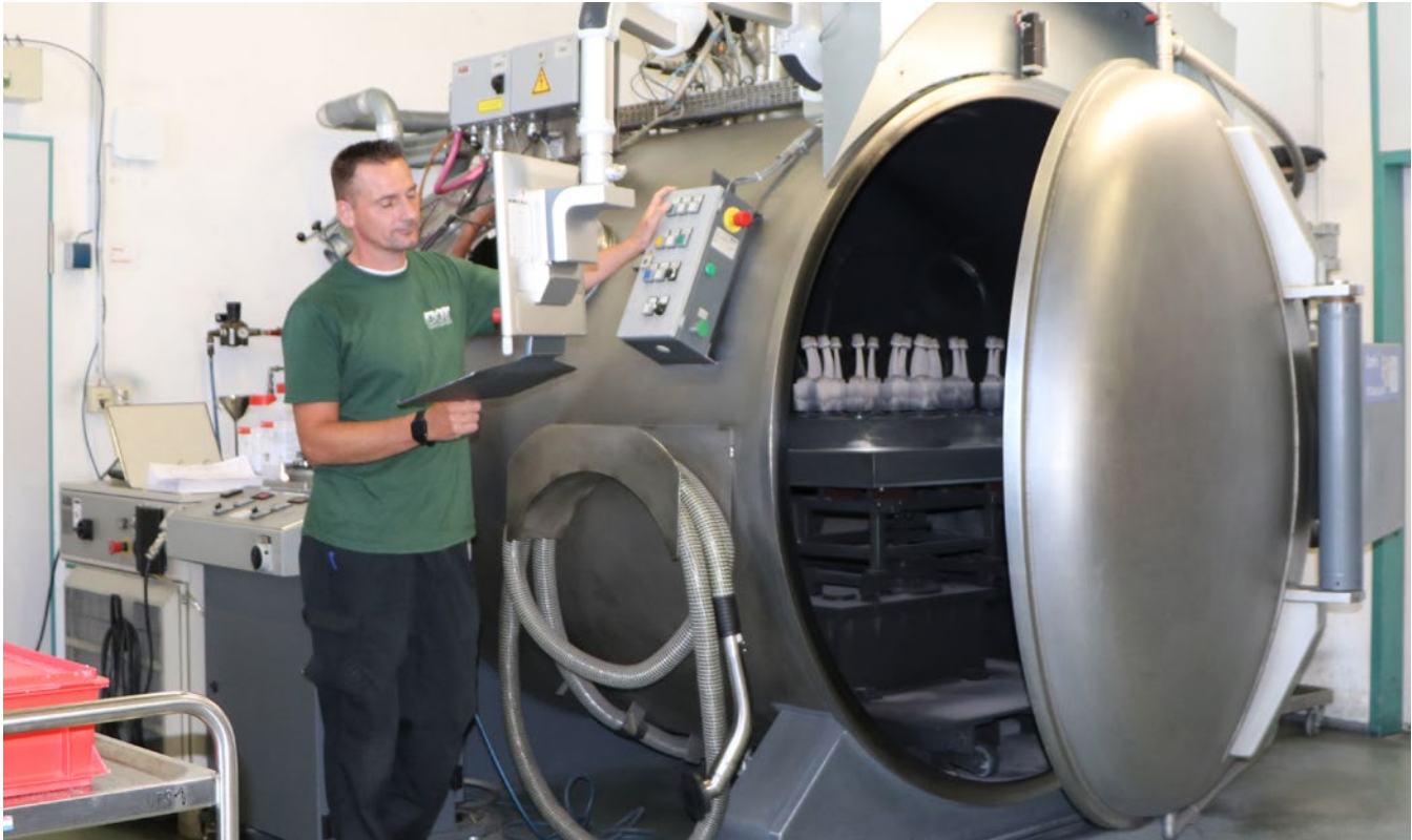
VPS-Anlage mit DOT-Mitarbeiter
