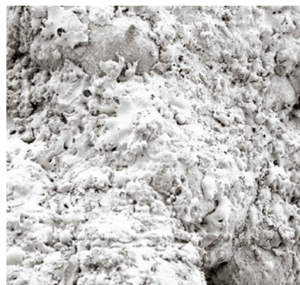
REM-Aufnahmen einer HA-gespritzten Oberfläche
